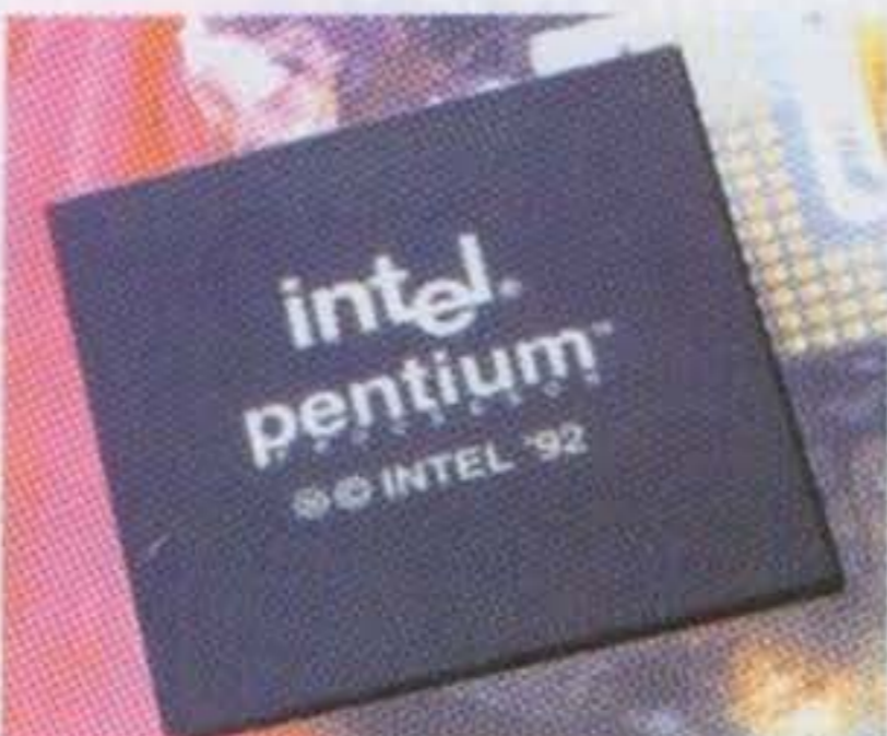
Pentium, il nuovo gioiello firmato Intel. Architettura Interna ed esterna a 64 bit, con due pipeline per le istruzioni.
